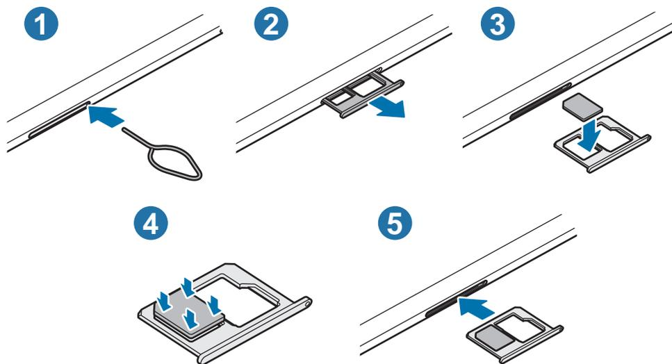
**1** Insérez l'outil de retrait à l'endroit prévu à cet effet sur le compartiment pour le déverrouiller.
