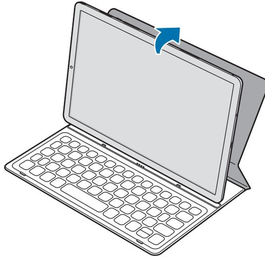
2 Insérez la tablette dans l'orifice de connexion pour qu'elle s'adapte aux connecteurs de la tablette et aux ports de la station d'accueil.
