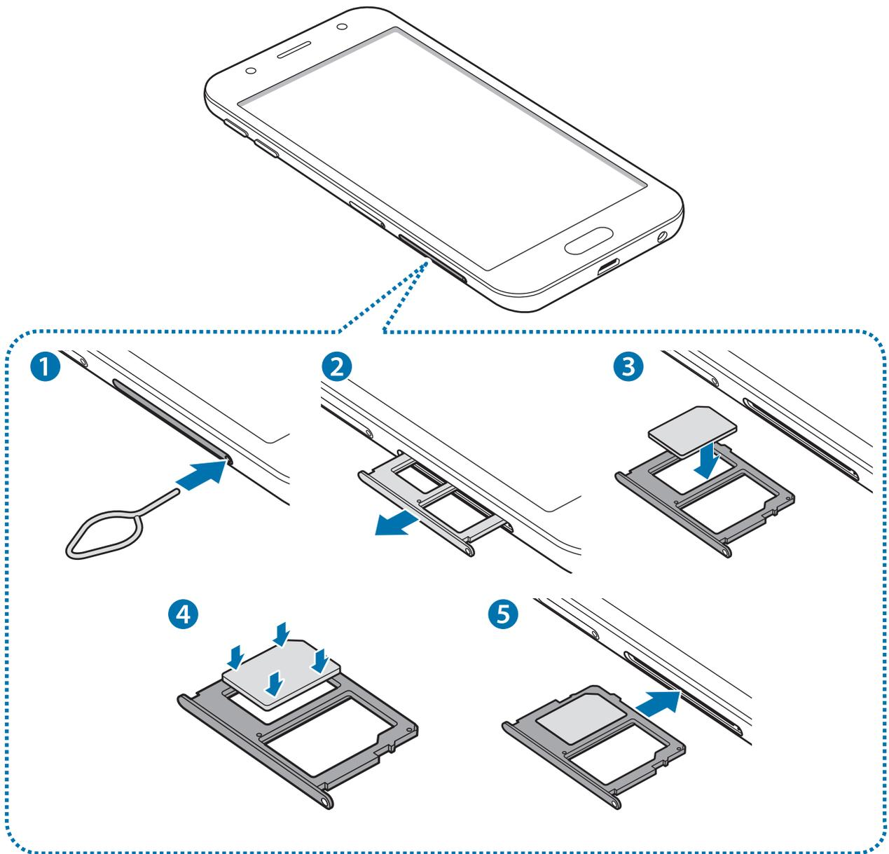
1 Insérez l'outil de retrait à l'endroit prévu à cet effet sur le compartiment de la carte mémoire et appuyez et relâchez pour déverrouiller le compartiment.
