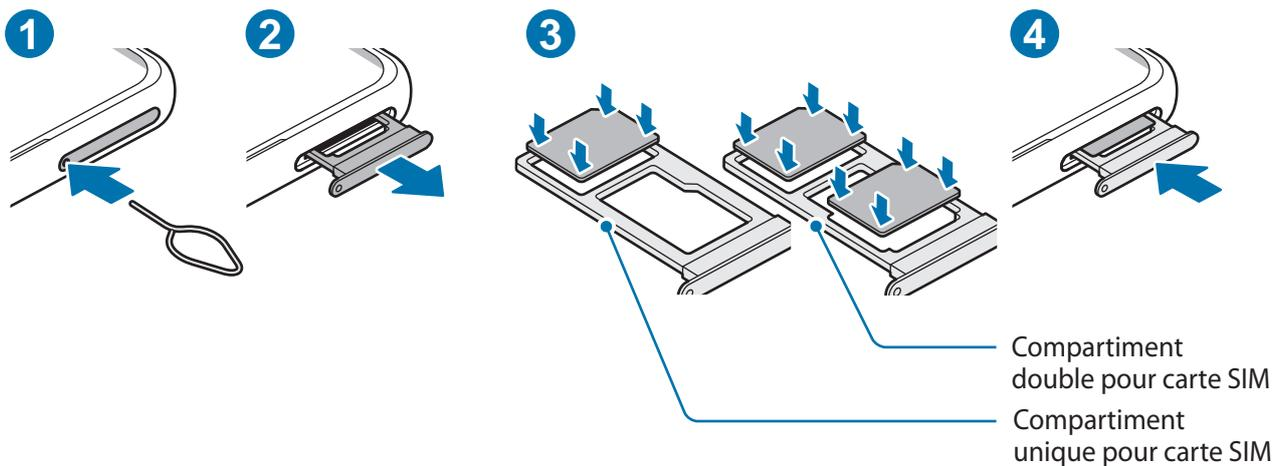
1 Insérez l'outil de retrait à l'endroit prévu à cet effet sur le compartiment pour le déverrouiller.
