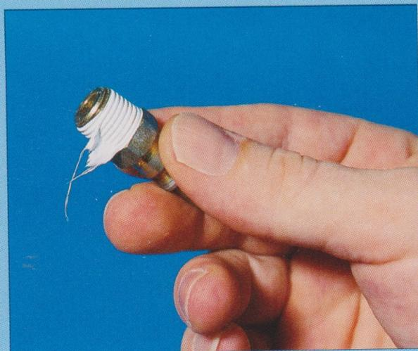
(Photo 4) Lorsque vous avez enroulé suffisamment de téflon (pour les grands filetages 4 à 6 fois), on tire sur la bande téflon. Le bout de bande arrachée (voir photo) est pressé avec les doigts sur le filetage (toujours dans le sens d'enroulement).
