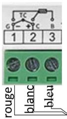
Détail du branchement de la sonde sur le thermostat
