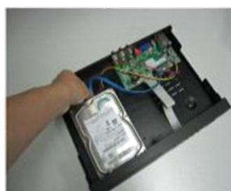
⑥ Connectez les nappes de données et d'alimentation au disque
