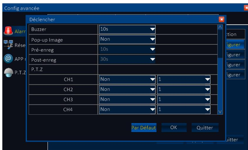
Enregistrement: Cochez la/les voie(s) pour lesquelles vous souhaitez déclencher l'enregistrement en cas de détection sur la voie sélectionnées.
