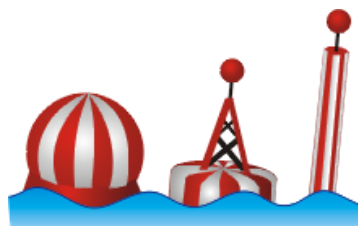
Marque d'eaux saines
