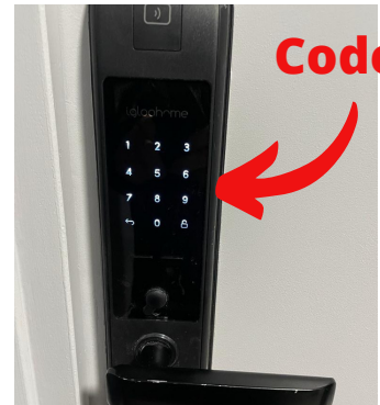
To enter the code that you must have received by email beforehand, simply put your hand in front of the numbers, they will light up automatically/ Pour saisir le code que vous avez dû recevoir par email au préalable, il vous suffit de passer votre main devant les chiffres, ils s'allumeront automatiquement.
