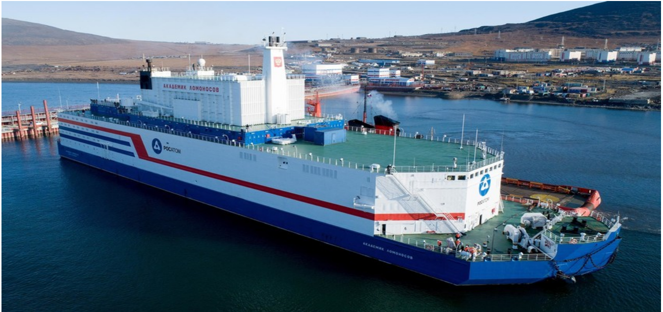
Figure 4 : l'Akademik Lomonosov, centrale nucléaire flottante russe (source : Russia Beyond)
