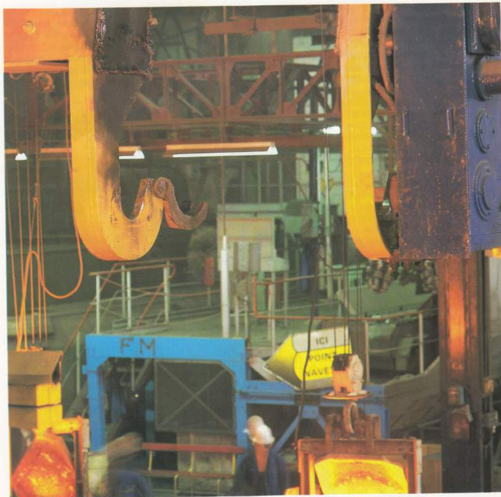
Très nombreuses sont les mesures qui ont été prises pour le transport du métal liquide : 1.200.000 francs d'investissements pour les ponts 10 tonnes. On voit ici l'un de ces ponts prévu pour le chantier des vilebrequins. Le palonnier est équipé de deux paliers de bridage, qui permettent d'immobiliser la poche pendant les différentes opérations de manutention.
