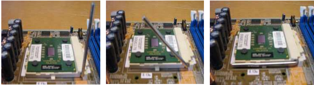
Figure 168 – Fixation du processeur dans un socket « zero force »
