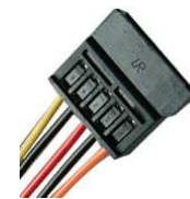
Figure 89 Connecteur d'alimentation des disques SATA
