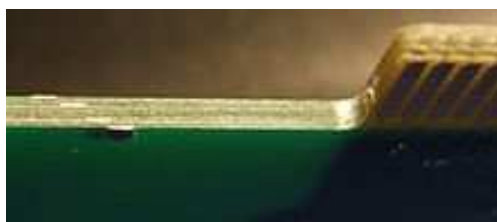
Figure 68 – Circuits imprimés quatre couches (Photos Wikipédia)
