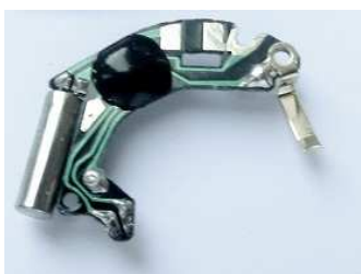
Figure 64 - Circuit imprimé d'une montre bracelet
