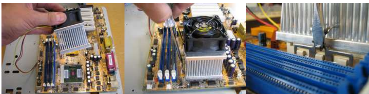
Figure 169 – Montage d'un ventirad
