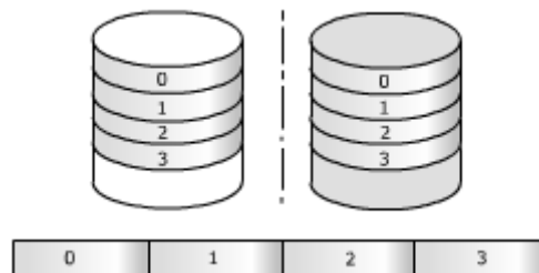
Figure 137 Enregistrement de quatre bandes sur deux disques en miroir
