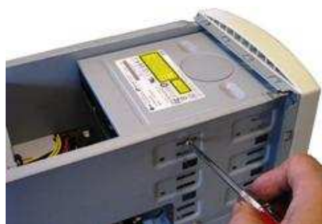
Figure 175 – Fixation des disques
