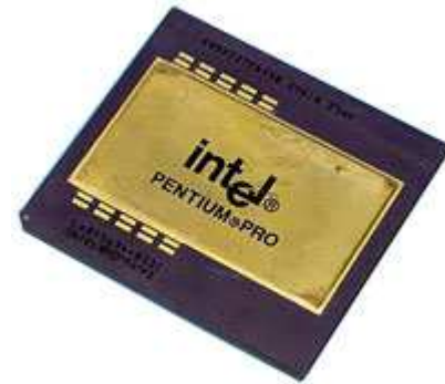
Figure 98 – Pentium Pro Première tentative d'inclure la cache de niveau 2 au boîtier du processeur
