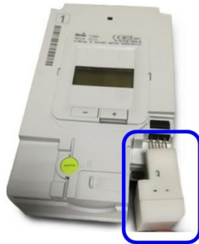
ERL (Emetteur Radio Linky) A fréquences ZigBee
