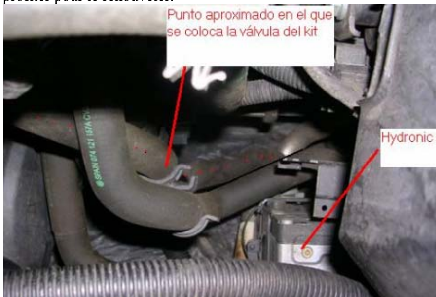
Photo 12 Endroit où loger la valve.
