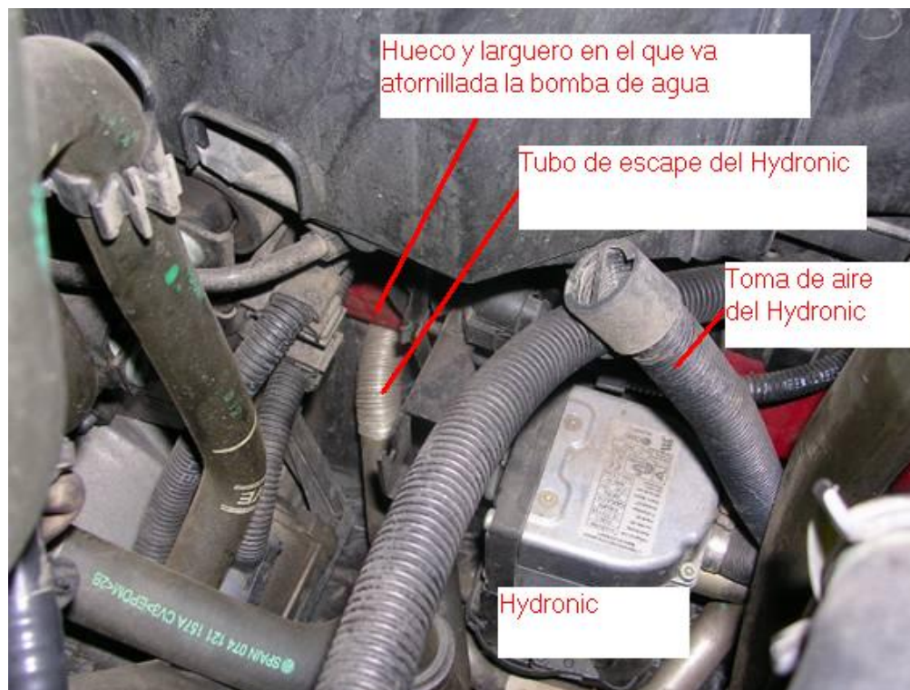
Photo 7 Vue supérieure de l'Hydronic et de l'emplacement de la pompe
