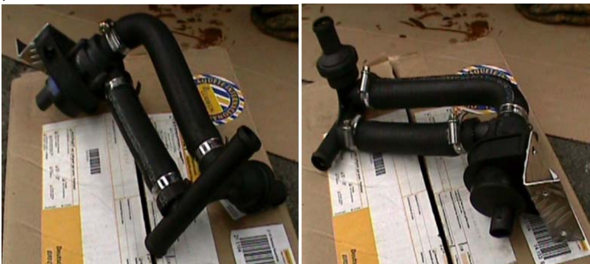
Photo 9 et 10 Montage de la combinaison pompe valve et manchons.
