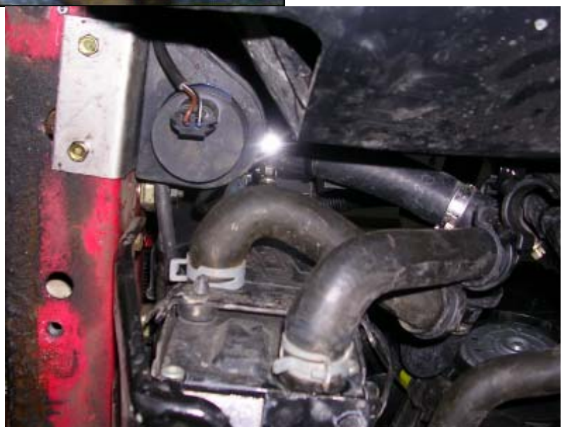
Photo 13 : Valve combinée et extrémité à unir à la valve T
