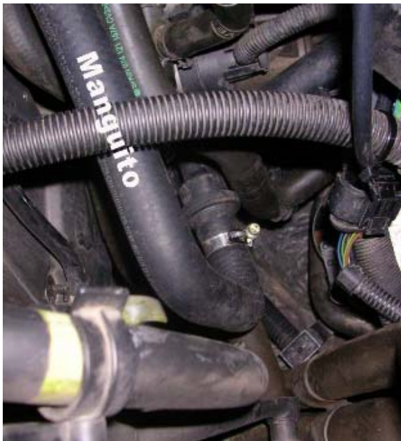
Photo 19 : Durite sortant de la valve combinée au T du kit
