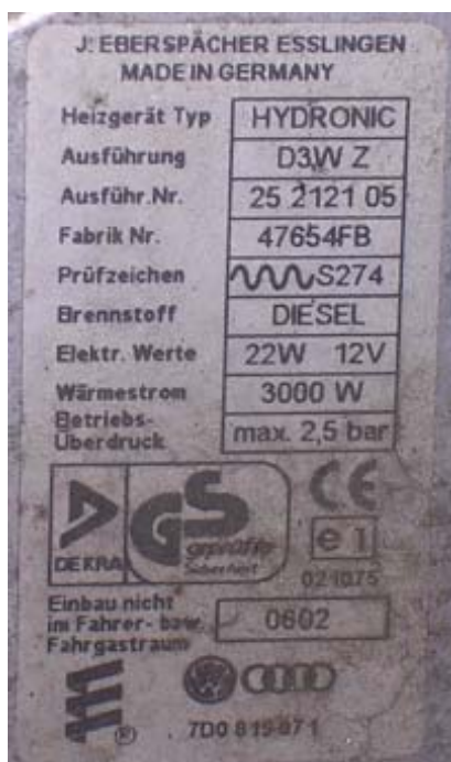
Foto 1. Plaque caractéristiques Hydronic D3WZ
