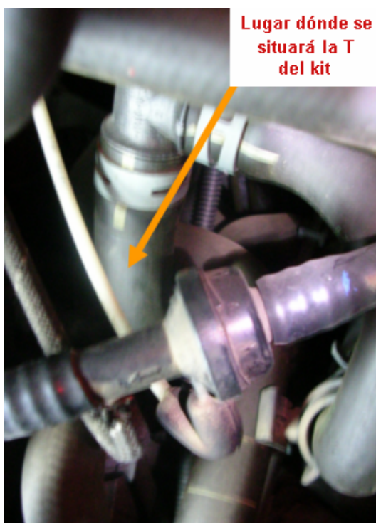
Photo 15 Endroit où se monte le T du kit
