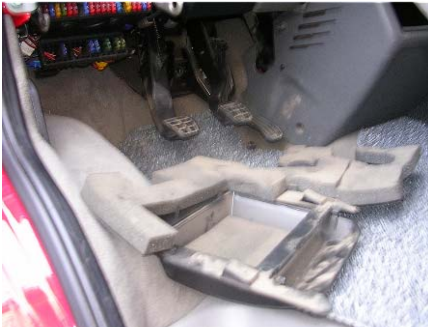
Photo 25 : Couvercle noir inférieur des fusibles.
