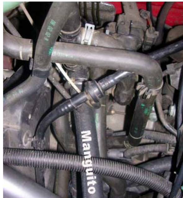
FPhoto 20 : Durite sortant du T vers la valve combinée
