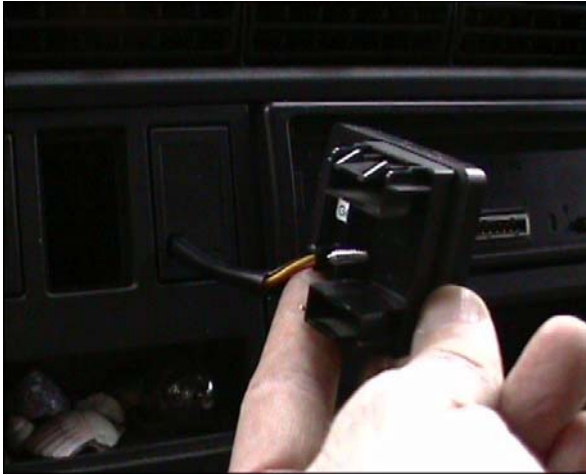
Photo 30 : Programmeur dans le tableau de bord
