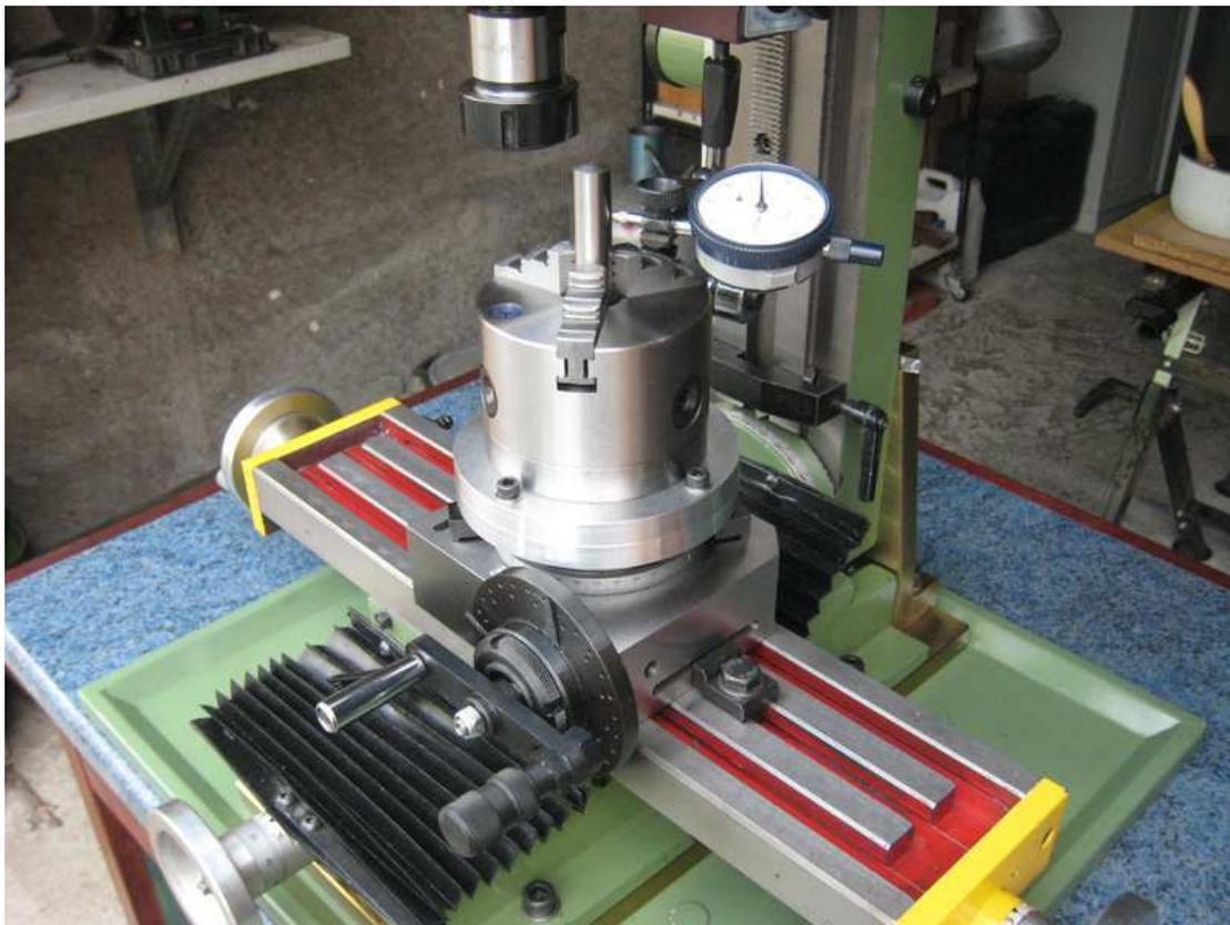
Pour obtenir un centrage meilleur que 0.1 mm de l'axe de la goupille de 16 mm par rapport à l'axe de rotation du plateau du diviseur, il convient d'affiner l'opération au comparateur.
