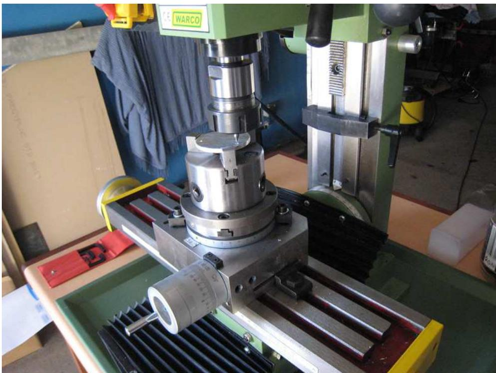
Voici le tambour gradué. Nous l'avons utilisé pour percer 3 trous à  $120^\circ$
