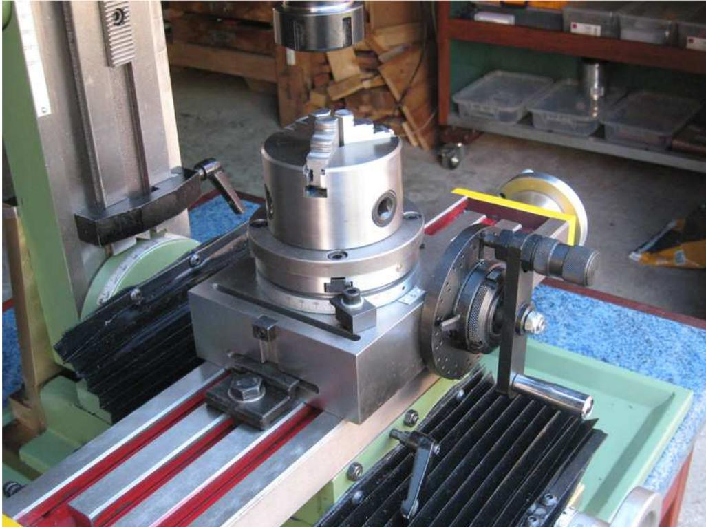
Ici le diviseur est en position axe vertical. Il comporte une table circulaire de 100 mm avec 4 rainures en T
