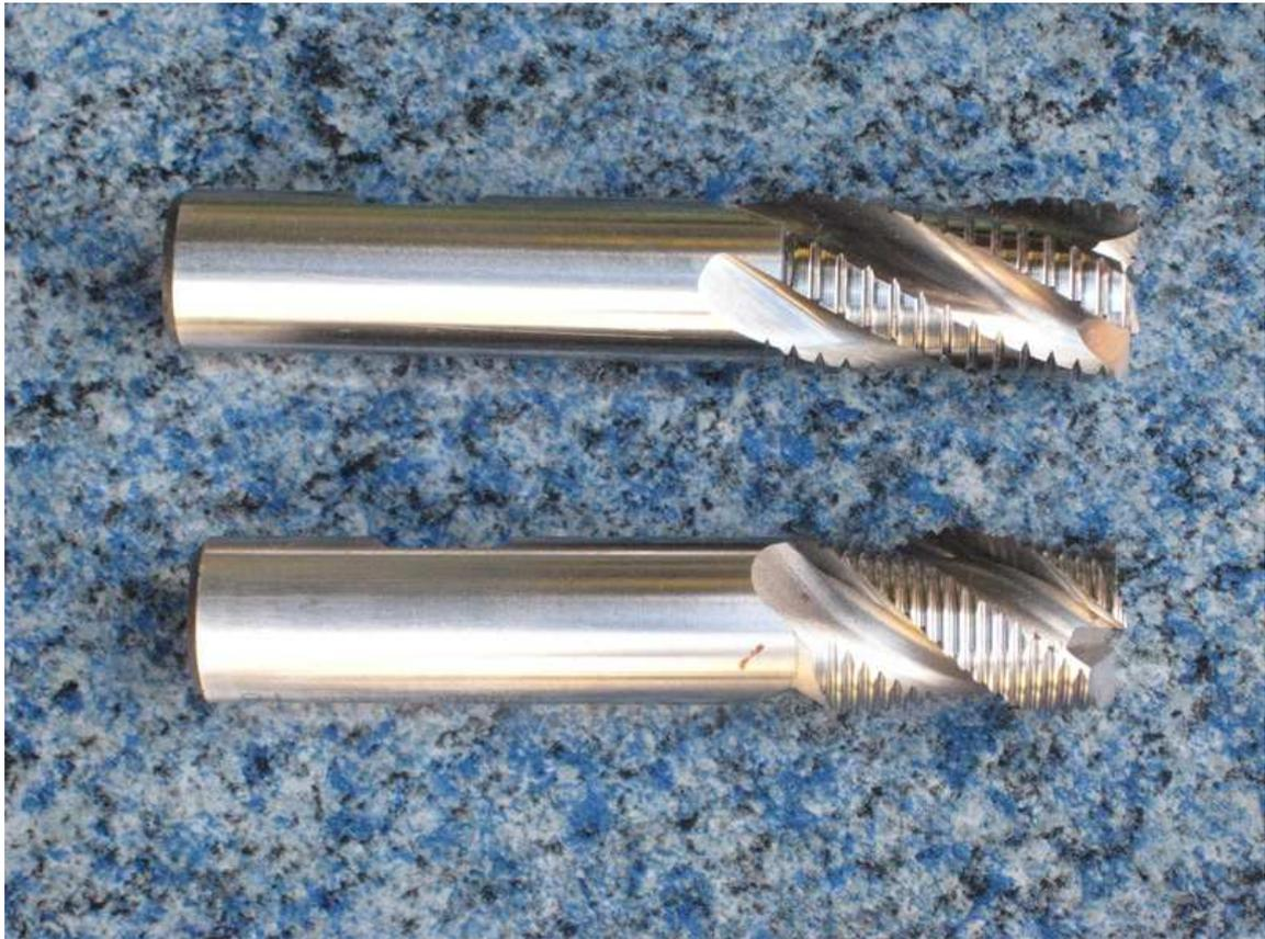
La **fraise d'ébauche** est une fraise dont la partie coupante des dents est munie de brise-copeaux disposés en spirale sur le pourtour de la fraise.
