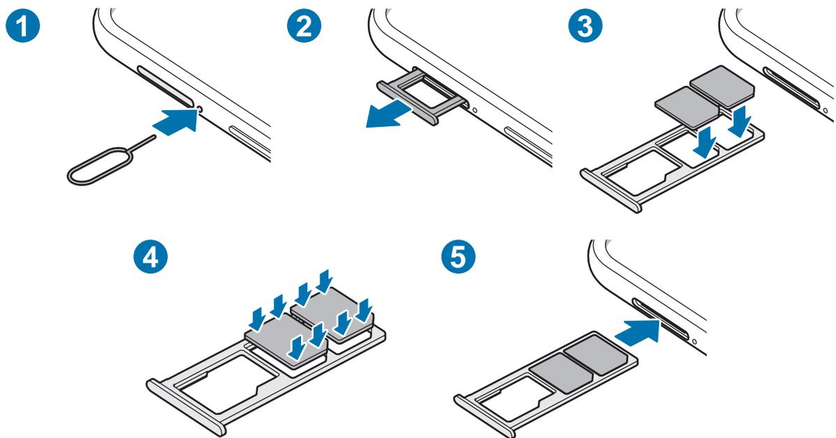
1 Insérez l'outil de retrait à l'endroit prévu à cet effet à côté du compartiment pour le déverrouiller.
